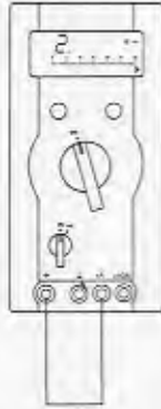
Sicherung hat Unterbrechung: Anzeige „2“ V~
